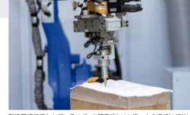
製造現場で使われているロボット超音波トリム機。人の手では切りにく いような複雑な形でも簡単にトリミングできる
